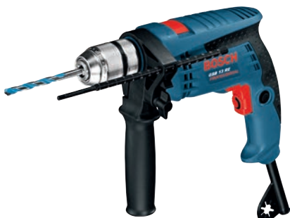
TALADRO PERCUTOR GSB13RE 600W 7175875 Reversible. Velocidad variable. Portabrocas automático de 13 mm.
