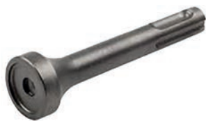
HERRAMIENTA PERCUTORA SDS-PLUS 23040770 Vástago se acero templado SDS-plus para martillo percutor. Superficie de impacto Ø 17 mm, borde perimetral de 1,5 mm.
